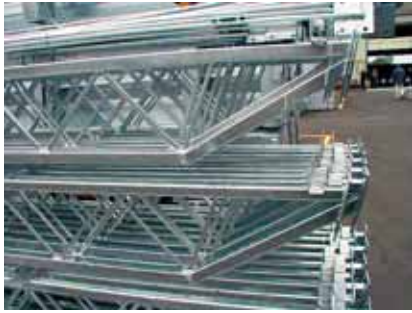
Kuumasinkittyjä kattoristikoita. Rajoitettu piipitoisuus.
